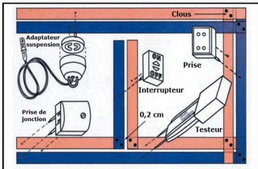
Les luminaires seront fixés sur des adaptateurs à fixer sur le ruban conducteur (suspensions, appliques et plafonniers). Les lampes et lampadaires seront reliés à des prises à clouer ck1003-1/mh0776 sur le ruban conducteur. Chaque point lumineux peut être commandé par un interrupteur indépendant CK1011.
