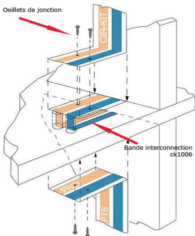
Le circuit électrique doit être continu et la connexion entre deux rubans se fait à l'aide de clous ou œillets de jonction selon l'épaisseur du bois. La continuité du circuit électrique d'une pièce à l'autre peut être assurée par un élément de traversée CK1006 (mur ou plafond) ou tout simplement en passant par le sol et profiter des ouvertures de portes.
